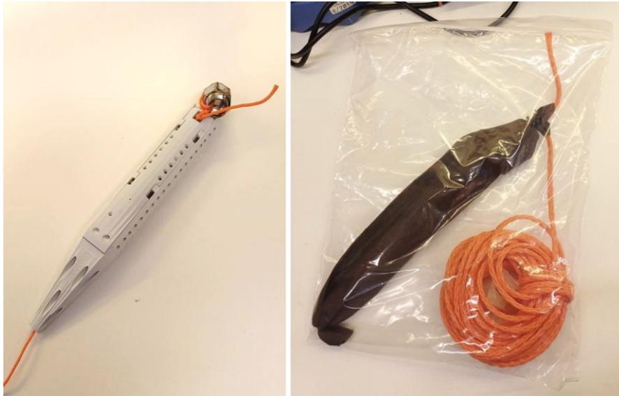
Figure 3. Échantillonneur de type « torpille » entièrement assemblé avec le poids (à gauche) et l'emballage supplémentaire avec le tissu d'ombrage (à droite). Photos : THL.
